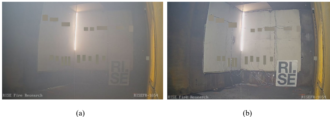
Figur 4-5: Illustrerer hvordan sikten var i rommet med trekrybbe som brensel og ulike ventilasjonsrater etter 30 minutter. (a) ingen mekanisk ventilasjon, forsøk 3, og (b) 16 luftutskiftninger i timen, forsøk 7.
