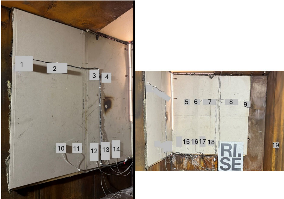
Figur 3-2: Viser hvor de ulike sensorene var montert i korridoren. Numrene er de samme som ID numrene i Tabell 3-1. Bildet til venstre viser sensorene montert på veggen til venstre når man går inn i rommet, mens bildet til høyre viser sensorene som er montert på veggen rett frem i tillegg til sensor nummer 19 som var montert på vegg til høyre.
