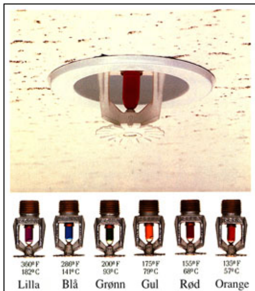
Fig. 4-5 Sprinklerhoder med ulike fargekoder for utløsningstemperatur
