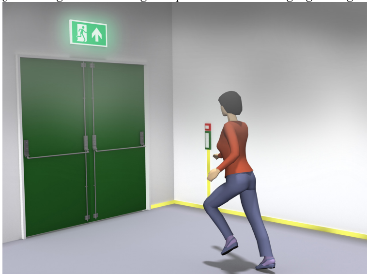
§ 11-12 Figur 2: Markeringsskilt plasseres over alle utganger til og i rømningsvei.
